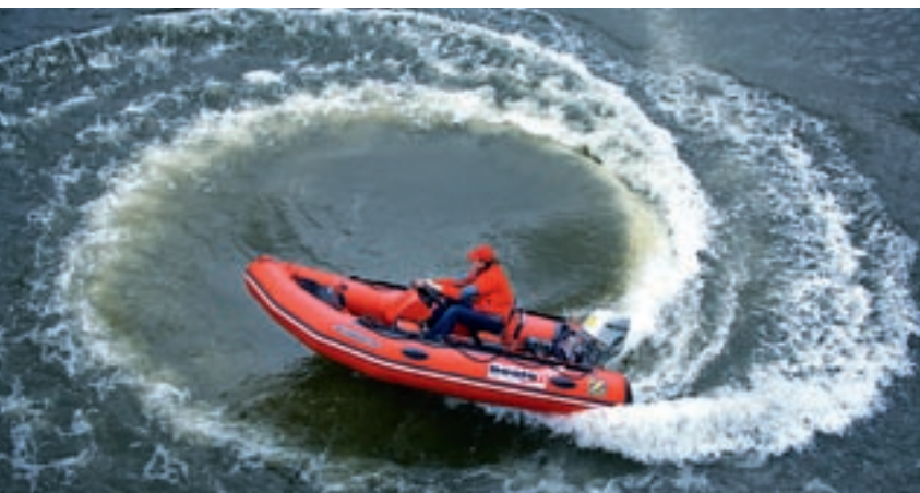
Propellerventilation Fehlanzeige: Zodiacs Futura lässt sich mit allen Testmotoren problemlos in enge Kurven und Kreise steuern.
